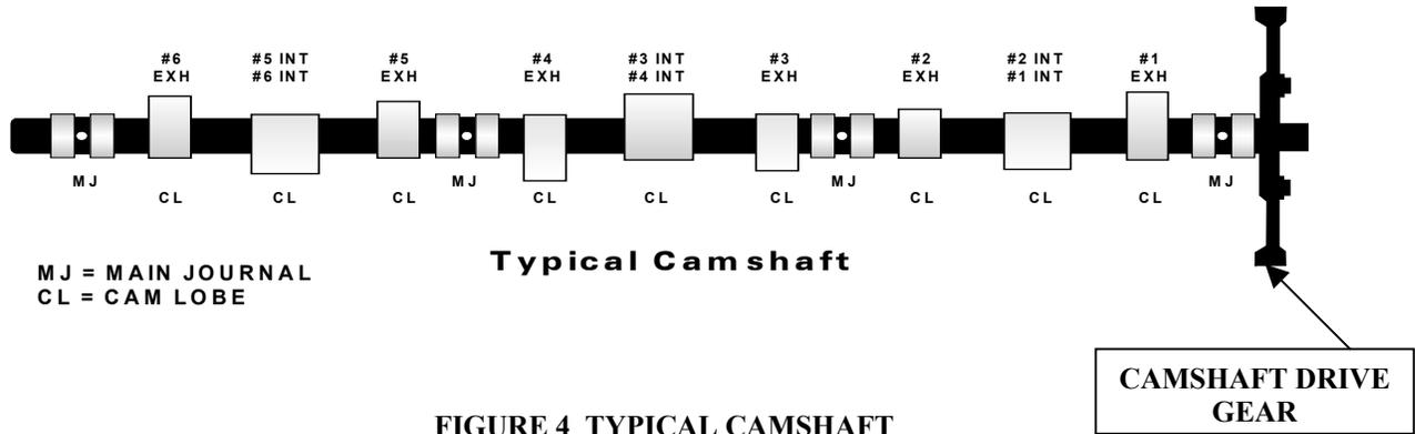
**FIGURE 4 TYPICAL CAMSHAFT**
